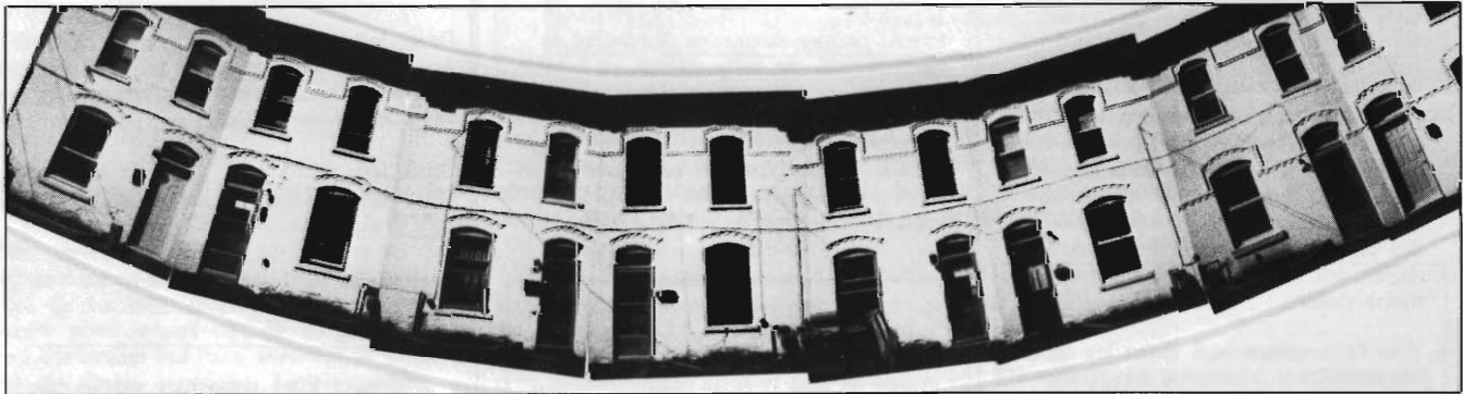
6) Un relevé photographique fait avec une lentille normale (50 mm) dont la perspective n'a pas été corrigée: le résultat donne une mosaïque en forme de U (voir fig. 7).
